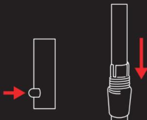
Pressione a trava de metal e insira o cilindro superior no cilindro inferior até que encaixe em um dos pontos circulares. Empurre a trava novamente para ajustar na altura desejada.
